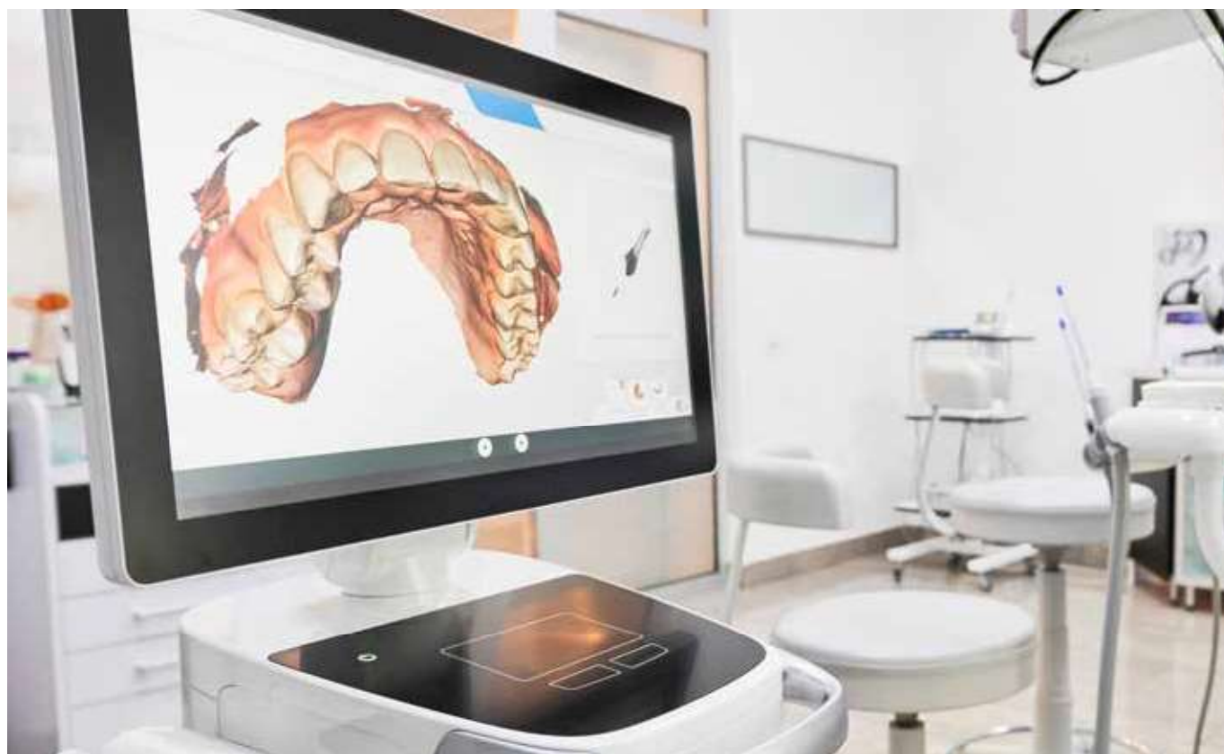
Auch in der Zahnmedizin schreitet die Digitalisierung schnell voran: zahnmedizinisches System zum intraoralen Scannen.
